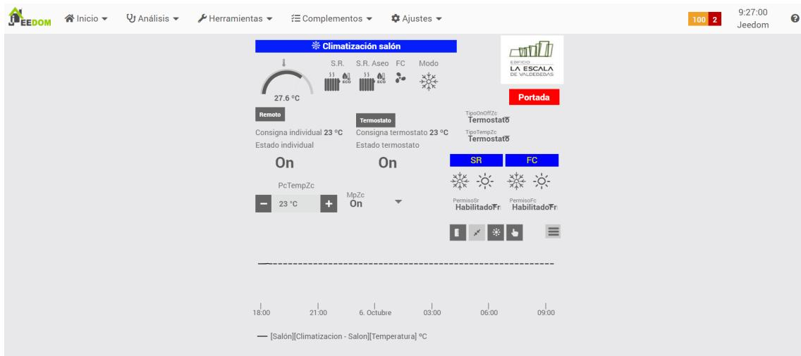
Está dividida en tres secciones, en la parte superior tenemos una serie de datos de lectura del funcionamiento de la sala, como por ejemplo, la temperatura de la sala, el estado de las válvulas y fancoil y el modo de funcionamiento del sistema (no es modificable).
