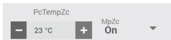
En la ventana de salón, tenemos la misma opción que disponemos en el termostato para configurar el funcionamiento de la instalación de suelo radiante y / o fancoil. Es indiferente modificarlo desde el termostato o desde la aplicación.
